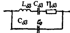
ნახ. 1.4. კვარცული რეზონატორის ექვივალენტური სქემა
